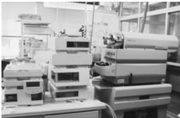
高速液体クロマトグラフ部分 タンデム質量分析計部分 写真 液体クロマトグラフ/タンデム質量分析計 (LC/MS/MS)
