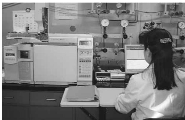
写真：ガスクロマトグラフ質量分析計
